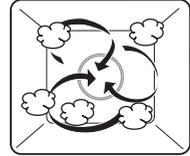
L'espace de cuisson est simultanément chauffé avec de la vapeur et de l'air chaud. L'aliment à cuire est chauffé ou cuit par la vapeur.
